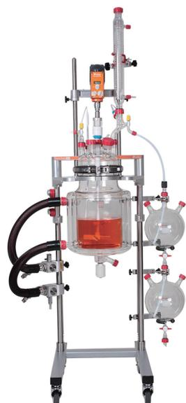
Reflux Divider kit を使用すると、コンデンサーで凝縮した溶媒蒸気をリアクターに還流するか、別の受器 (Receiver Flask) に移すことができます。これにより、溶媒交換や蒸留を簡単に行うことが可能です。キットには、オプションで蒸気温度センサーを取り付けることも可能です。
