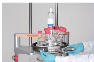
溝のないフラットフランジには、中心に配置するための PTFE カラーに取り付けられた Oリングを使用します。
