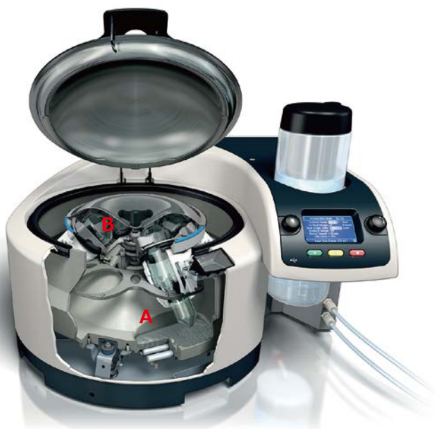
アウターチャンバー (A) : 低温スチームを発生させるために減圧 インナーチャンバー (B) : サンプル沸点を下げるために減圧
