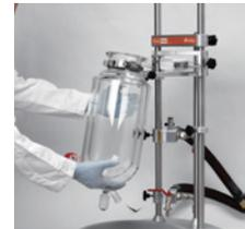
専用工具などを必要とせず、1人でも簡単にベッセルの交換が可能です。
