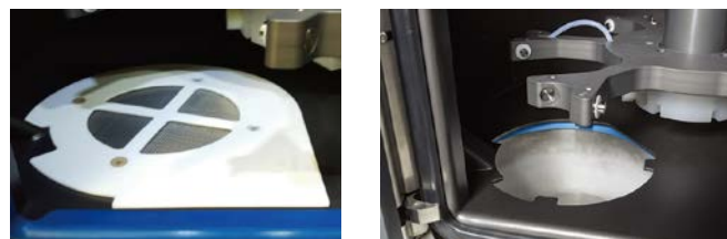
遠心チャンバー下部に設置された一体型コンデンサー
