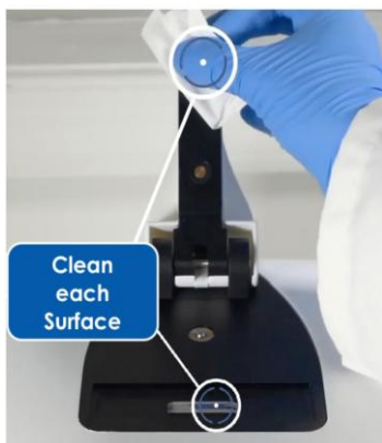
図 1: 乾いた実験用ワイプで、チャンバーの上面と下面をきれいに拭いてください。
