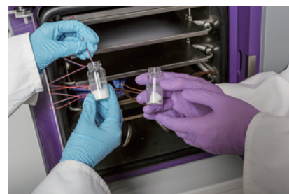
熱電対プローブで プロダクト温度をモニタリング
