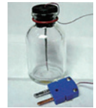
打栓バイアル対応の 温度プローブ
