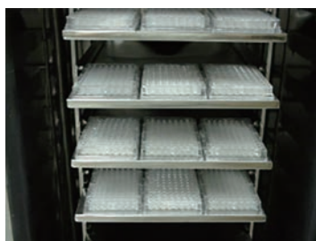
棚板 1 枚に 96 ウェルプレート 12 枚搭載可能
