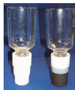
濃縮用（左）：素材 ポリプロピレン（PP） 乾固用（右）：素材 アルミニウム / PP
